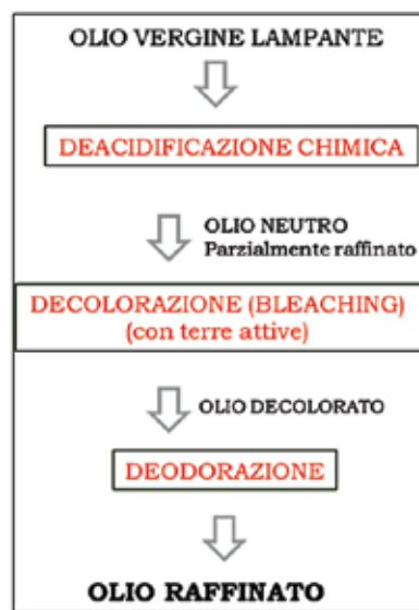
Figura 6. Schema generale del processo di raffinazione degli oli lampanti
